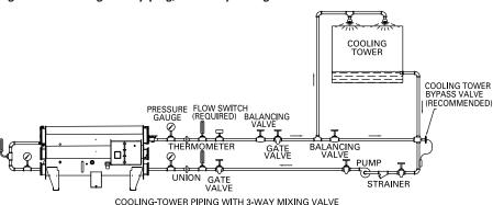
COOLING-TOWER PIPING WITH 3-WAY MIXING VALVE RECOMMENDED FOR LOWER TOWER TEMPS
